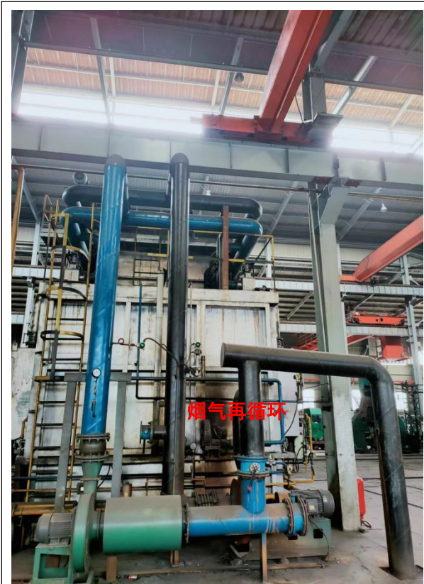
4#20t 天然气加热炉低氮燃烧装置 (低氮燃烧器+烟气再循环)
